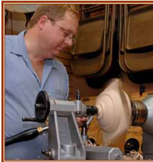
Leveling the square edge
